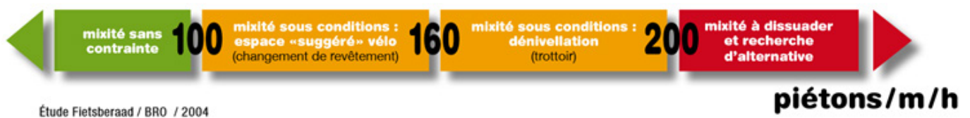
Figure 9 : Ce schéma montre le type de séparation le mieux adapté selon le nombre de piétons par mètre et par heure 17
